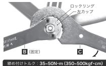
※締め付け後、ロックリングと BBシェルが全周密着している ことを確認してください。 隙間がある場合、BBが緩む恐 れがあります。
